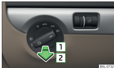
Илл. 46 Переключатель освещения: включение противотуманных фар/заднего противотуманно- го фонаря
