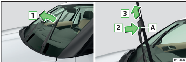
Илл. 191 Замена щётки стеклоочистителя ветрового стекла
