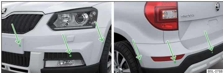
Илл. 134 Место установки датчиков на левой стороне автомобиля: спереди/сзади
