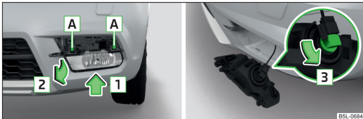
Илл. 203 Извлечение противотуманной фары/замена лампы накаливания
